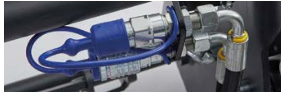
Zusätzliche Hydraulikleitung am Anbaugeräteschnellwechsler
